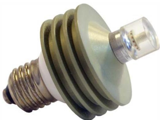
Лампы предназначены для работы в аппаратах светового ограждения, например, типа ЗОЛ или ЗОМ или других светосигнальных аппаратах. Светотехнические параметры ламп соответствуют требованиям АП-170 межгосударственного авиационного комитета (МАК), а лампы, предназначенные для работы в условиях аэродромов, – и требованиям РЭГА-94.
